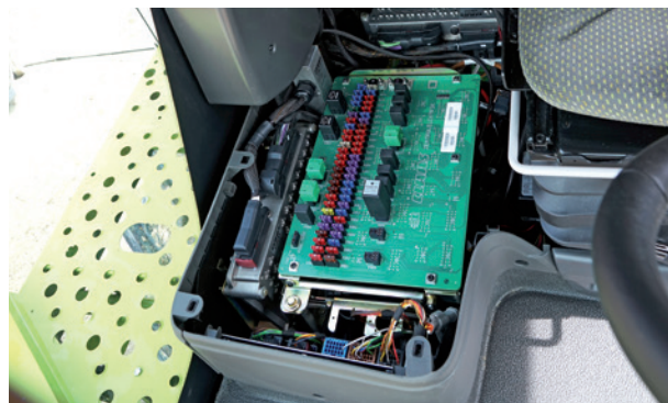
La nuova centralina di controllo del livellamento è posizionata dentro la cabina in ambiente protetto
