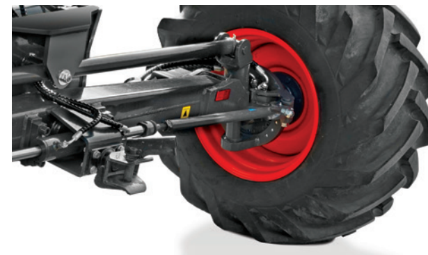
Trazione 4TRAC di serie, con motori idraulici ad elevata coppia di spinta, l'inserimento/disinserimento viene gestito automaticamente o manualmente tramite il CEBIS
