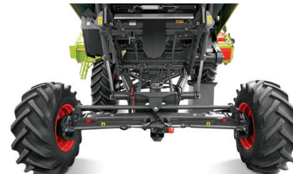
Nuovo livellamento posteriore, per un miglior comfort e maneggevolezza nella testata
